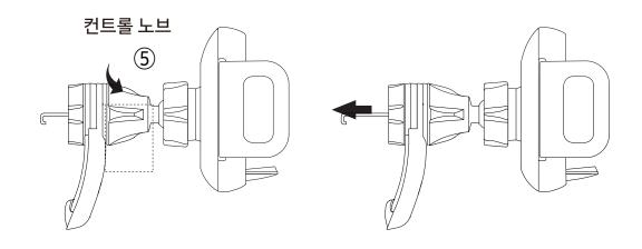
• 컨트롤 노브를 시계 방향으로 돌려서 송풍구에 고정될 수 있도록 하고 ⑥, 동봉된 충전 케이블의 USB-C 단자는 차량용 무선 충전기 하단의 USB-C 포트에 연결합니다. 차량용 시거잭 충전기\*의 ⑦ USB-A 포트에 동봉된 USB 케이블 USB-A 단자를 연결합니다.
