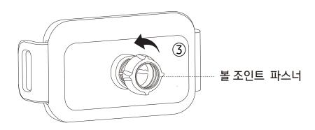
• 클립 ④ 에 볼 조인트 파스너를 끼우고 차량용 무선 충전기에 조립한 후 볼 조인트 파스너를 시계 방향으로 돌려 클립을 차량용 무선 충전기에 고정합니다.
